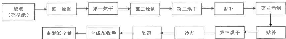
图 33-4 聚氨酯干法生产工艺流程图
