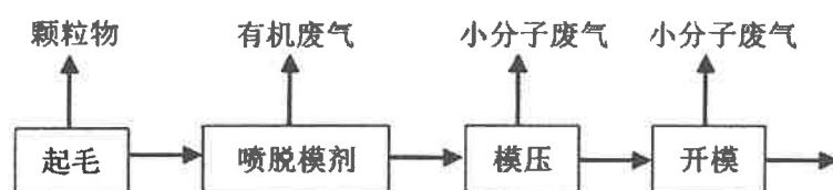
图 35-8 模压工艺-帮底装配单元工艺流程图
