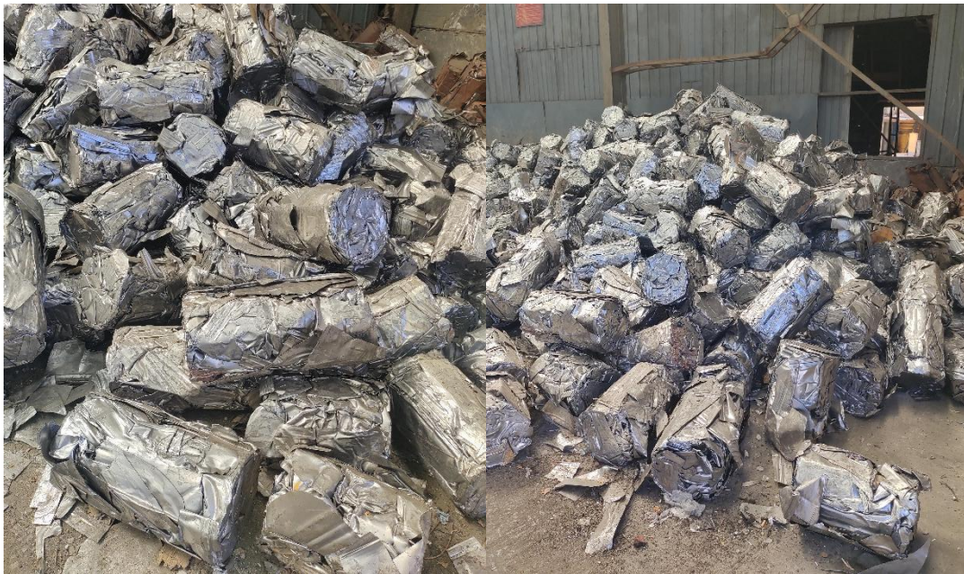
冷板压块废钢
