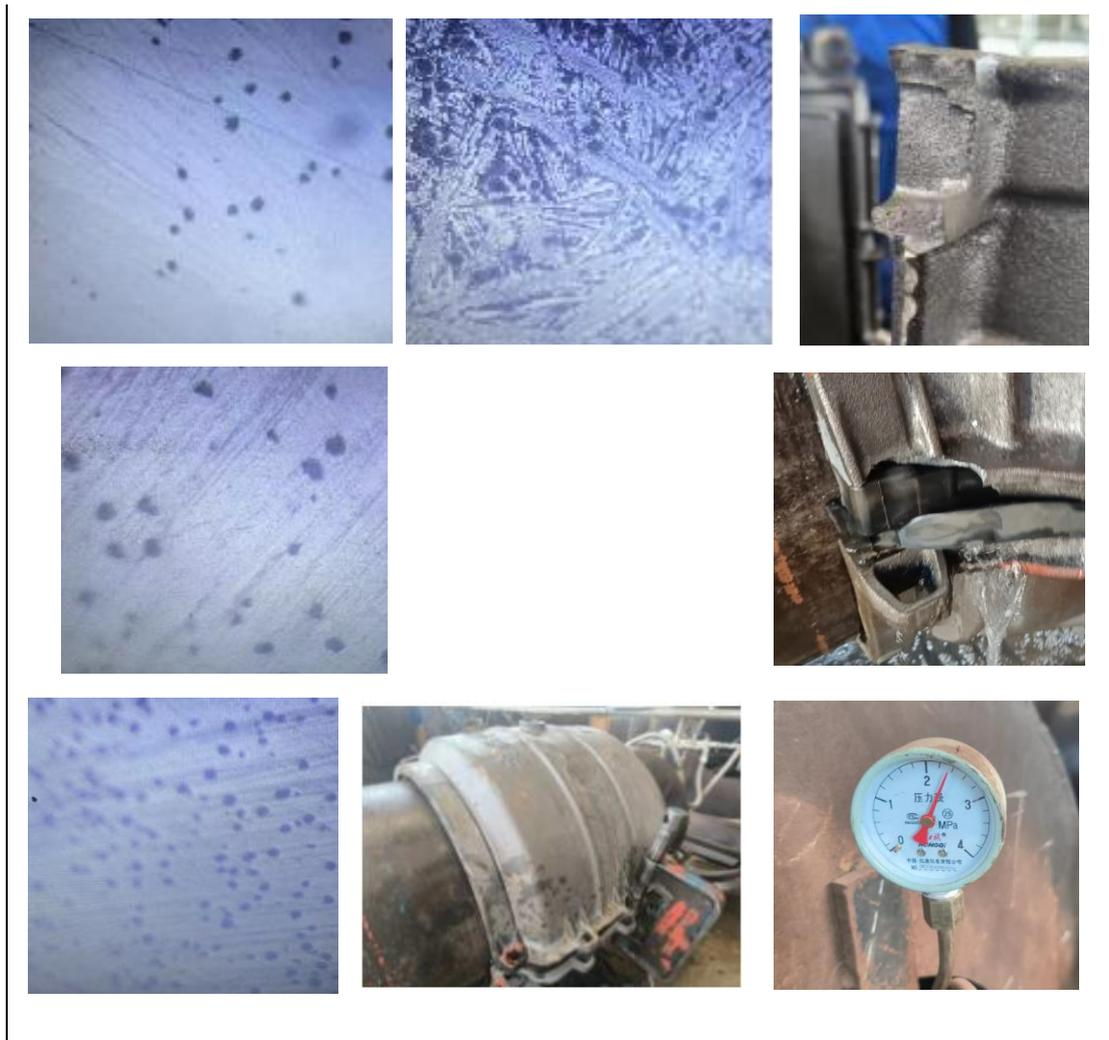
案例 1：Z150×1000 直管修补器，球颗粒数少，基体出现碳化物，壳体发生断裂。
