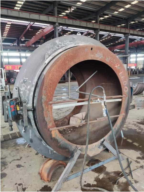
Z1600 承插修补器水压试压照片
