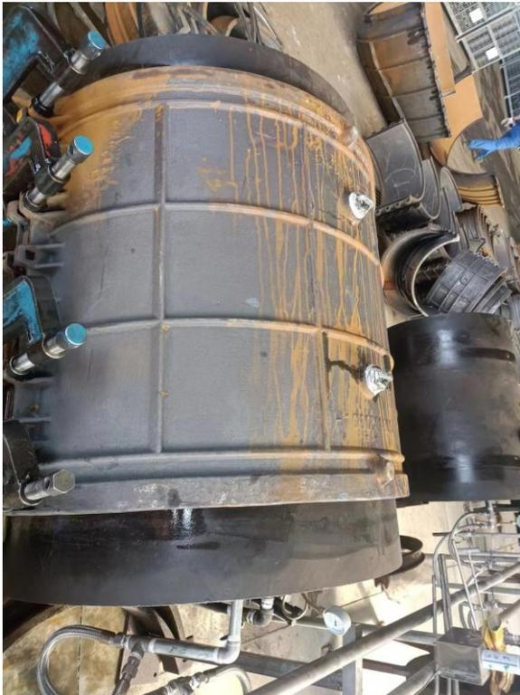
H1000X1000 直管修补器水压试压照片
