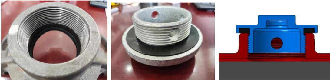
泄压孔圆柱内螺纹      泄压堵头圆柱外螺纹
