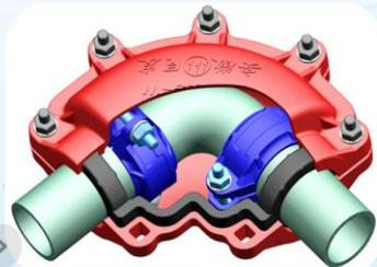
使用现场：某小区高层供水管道DN100卡箍接头部位渗漏，小区属于集中用水区域，无法采取停水更换卡箍的维修方式。采用DN100卡箍哈夫节，快速完成抢修。
