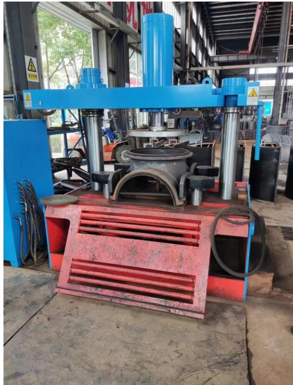
试压设备进行水压试验
