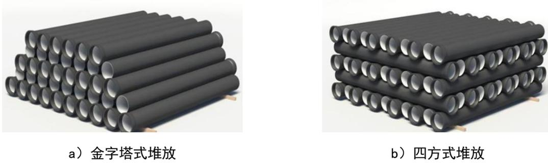
图4 球墨铸铁管堆放方式
