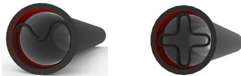
图6 密封圈的安装
