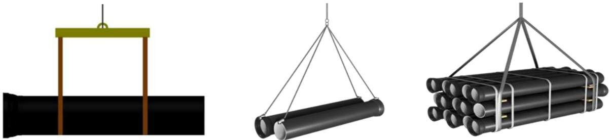
图2 球墨铸铁管起吊方式
