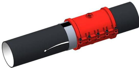
图 40 固定连接器, 安装哈夫节
