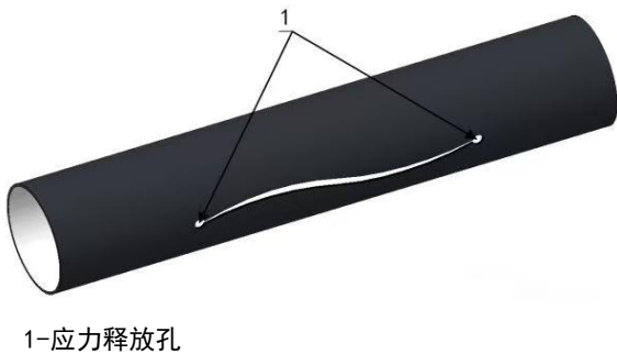
图 37 清理管道，两端钻打应力释放孔
