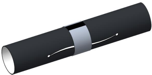
图 38 连接器置于抢修位置
